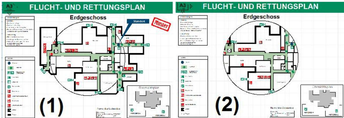
Das obige Bild verdeutlicht beispielhaft die Verwendung von Containern. Aus den einzelnen Elementen des Fluchtplanes und eines Kreisobjektes (1) wurde ein Container erzeugt (2), welcher die Darstellung des Fluchtplanes kreisförmig begrenzt.
