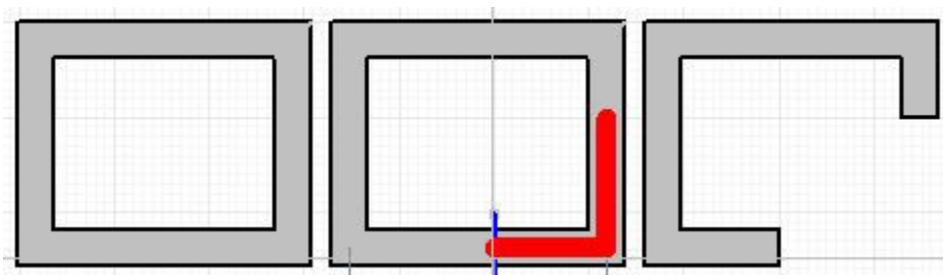
Schneidet aus einer bestehenden Wand ein Teilstück heraus. Wählen Sie dazu bitte den Startpunkt, sowie den Endpunkt der Teilwand, welche herausgeschnitten werden soll.
