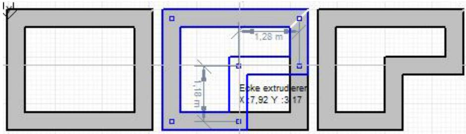
Fügt eine zusätzliche Ecke in einen bestehenden Wandzug ein. Wählen Sie zunächst die Ecke eines Raumes und ziehen Sie im folgenden Schritt die neu entstandene Ecke in den Raum hinein oder heraus.
