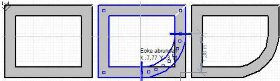
Rundet eine bestehende Ecke ab. Wählen Sie zunächst die Ecke aus und wählen anschließend den Rundungsradius durch Bewegen der Maus aus.
