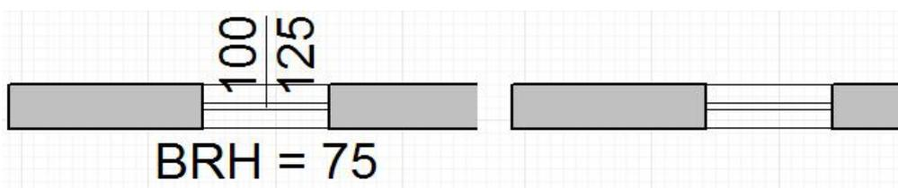
Neben der Breite, Höhe und Brüstungshöhe von Fenstern, lassen sich die Fensterrahmenbreite und die Position (außen, innen, mittig, benutzerdefiniert) des Fensterrahmens einstellen. Fenster lassen sich auf einer Wand entlang mit der Maus verschieben. Als Innenseite der Wand wird die rechte Seite in Richtung der Erstellung vordefiniert. Um diesen Effekt umzukehren, müssen Fenster gespiegelt werden.
