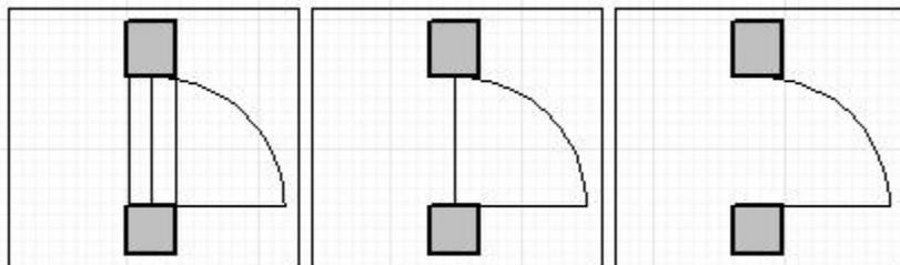
Türen lassen sich auf einer Wand durch das Halten der linken Maustaste und das Bewegen der Maus entlang der Wandachse verschieben. Sobald eine Tür markiert wurde, erscheinen 4 Markierungspunkte um die Tür herum. Klicken Sie auf einen der 4 Markierungspunkte, um die Tür in Richtung des gewählten Markierungspunktes parallel zur Wandachse zu spiegeln und um die Anschlagrichtung festzulegen.
